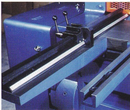
スライドストッパーとスケールの組合せ で迅速、確実な寸法出し
