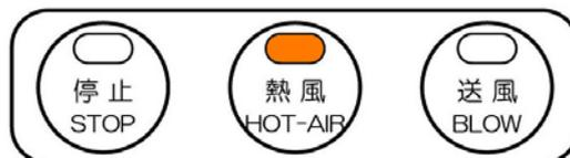
※外部運転による熱風発生機の停止後は20秒間再始動できません(再始動の待機状態は送風、または熱風ランプが点滅し、停止から20秒後に始動します)。また、外部ヒータ入/切のON/OFFを頻繁におこなうと内部リレーが短寿命となりますので、高頻度のヒータON/OFFを必要とする場合は、外部温度をご利用ください。
