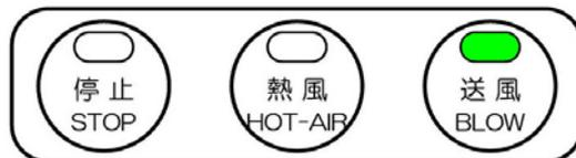
外部運転信号ON、外部ヒータ入/切信号OFFによる送風運転の場合、送風ランプ(緑)が点灯します。
